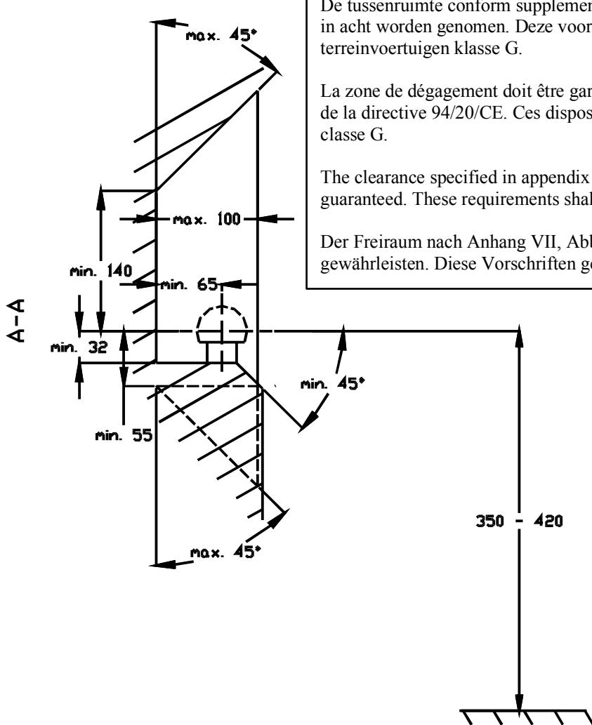
De tussenruimte conform supplement VII, afbeelding 30 van de richtlijn 94/20/EG moet in acht worden genomen. Deze voorschriften zijn niet van toepassing op terreinvoertuigen klasse G.
