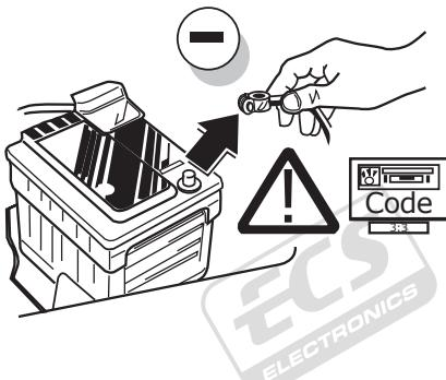
(DE) Um Störungen und Schäden am Bordnetz zu vermeiden, muss die Massepolklemme unbedingt vor Beginn aller Arbeiten von der Fahrzeughilfsbatterie getrennt werden! Insbesondere bei Arbeiten und Anschlüssen am CAN-Datenbus kann bei nicht abgeklemmter Batterie sowohl das Anhängermodul als auch das Fahrzeugseitige Bordnetzsteuergerät beschädigt werden! Bitte Herstellervorschriften beim Ab- und Anklemmen der Fahrzeughilfsbatterie beachten!
