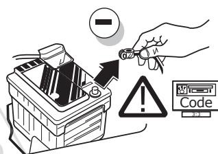
(DE) Um Störungen und Schäden am Bordnetz zu vermeiden, muss die Massenpolklemme unbedingt vor Beginn aller Arbeiten von der Fahrzeugbatterie getrennt werden! Insbesondere bei Arbeiten und Anschlüssen am CAN-Datenbus kann bei nicht abgeklemmter Batterie sowohl das Anhängermodul als auch das fahrzeugeigene Bordnetzsteuergerät beschädigt werden! Bitte Herstellervorschriften beim Ab- und Anklemmen der Fahrzeugbatterie beachten!
