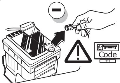
(DE) Um Störungen und Schäden am Bordnetz zu vermeiden, muss die Massepolklemme unbedingt vor Beginn aller Arbeiten von der Fahrzeugbatterie getrennt werden! Insbesondere bei Arbeiten und Anschlüssen am CAN-Datenbus kann bei nicht abgeklemmter Batterie sowohl das Anhängermodul als auch das fahrzeugeigene Bordnetzsteuergerät beschädigt werden! Bitte Herstellervorschriften beim Ab- und Anklemmen der Fahrzeugbatterie beachten!
