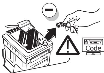
(DE) Um Störungen und Schäden am Bordnetz zu vermeiden, muss die Massepolklemme unbedingt vor Beginn aller Arbeiten von der Fahrzeubatterie getrennt werden! Insbesondere bei Arbeiten und Anschlüssen am CAN-Datenbus kann bei nicht abgeklemmter Batterie sowohl das Anhängermodul als auch das fahrzeugseitige Bordnetzsteuergerät beschädigt werden! Bitte Herstellervorschriften beim Ab- und Anklemmen der Fahrzeubatterie beachten!
