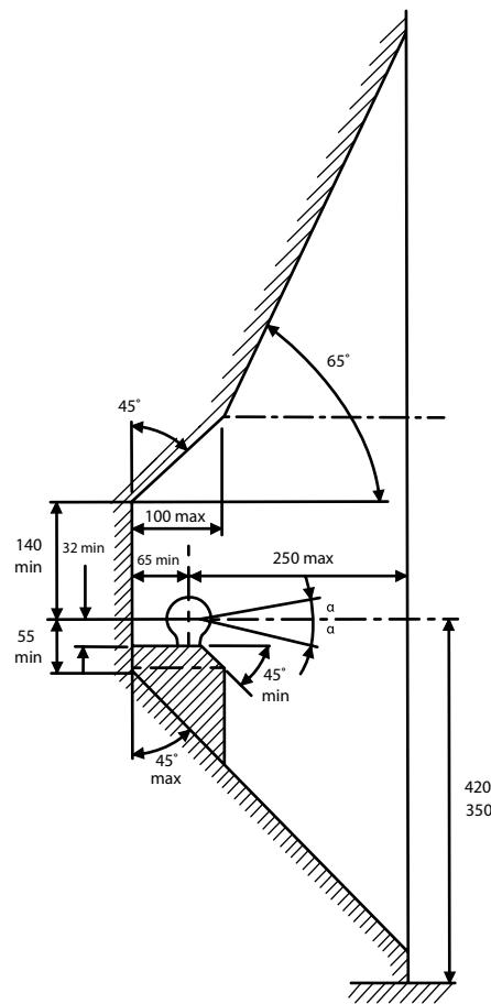
De tussenruimte conform bijlage VII, afbeelding 25 (a, b) van het reglement R55 UN/ECE moet in acht genomen worden. Deze voorschriften zijn niet van toepassing op terreinvoertuigen klasse G.
