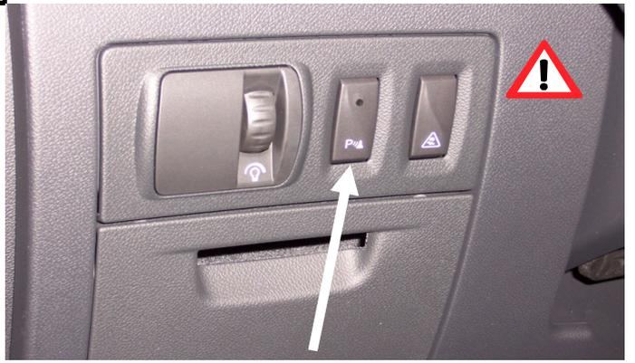
Lors du branchement de la remorque ,désactiver le système "RADAR DE RECUL" au tableau de bord
